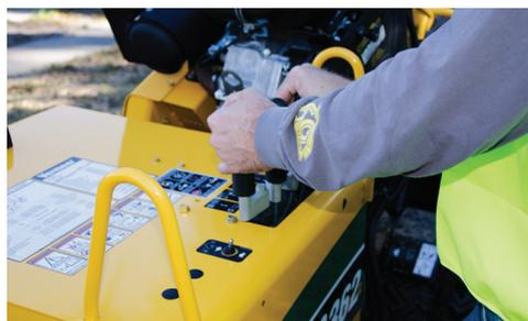
**SYSTÈME DE DÉTECTION DE PRÉSENCE DE L'OPÉRATEUR.** Les poignées de commande du déport du disque de coupe, de levage/descente du disque de coupe et de propulsion de la machine sont équipées d'un système de détection de présence de l'opérateur, ce qui assure également une détection de la capacité. Ce système de détection convivial de présence de l'opérateur protège les utilisateurs et contribue à améliorer leur sécurité.
