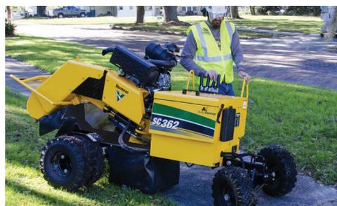
**DÉPLACEMENT AU SOL À DEUX VITESSES.** L'opérateur peut choisir une vitesse de déplacement au sol en haut régime de 0 à 40,5 m/min pour déplacer rapidement la machine ou choisir une vitesse plus faible à proximité de la souche, en sélectionnant le bas régime de 0 à 20,1 m/min.
