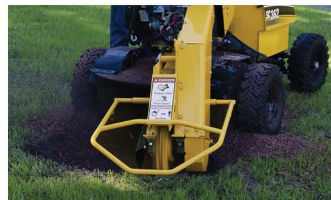
**SYSTÈME AUTOSWEEP®.** Cette fonction surveille le régime moteur et ajuste automatiquement la vitesse de balayage de la roue dessoucheuse. Elle a été conçue pour protéger le moteur, la transmission et réduire les contraintes structurelles tout en améliorant le rendement.
