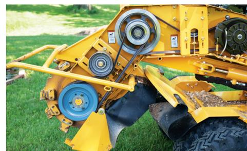
**ENTRETIEN PRATIQUE DES COURROIES.** Les courroies de la SC362 sont accessibles pour l'entretien depuis l'un des côtés de la machine et les courroies d'entraînement de la roue dessoucheuse sont réglables au moyen de roues folles amovibles. De plus, chaque courroie peut être réglée indépendamment sans compromettre le réglage des autres.
