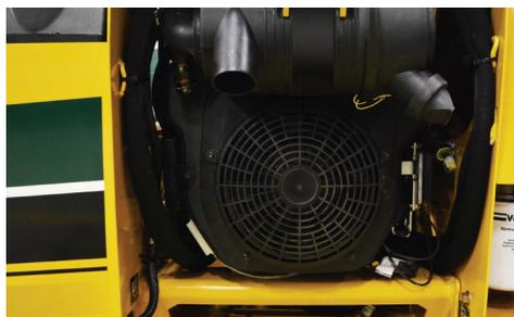
**MOTEUR À INJECTION ÉLECTRONIQUE DE 25 HP (18,6 KW).** Démarre parfaitement par temps froid, rend les câbles d'étrangleur inutiles et permet des économies de carburant par rapport aux moteurs à essence à carburateur équivalents.
