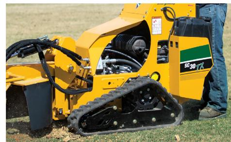
**ROUE DESSOUCHEUSE ET DÉPLACEMENT AU SOL À ENTRAÎNEMENT HYDRAULIQUE.** L'élimination des courroies ou des entraînements de chaîne permet de diminuer l'entretien et la maintenance.
