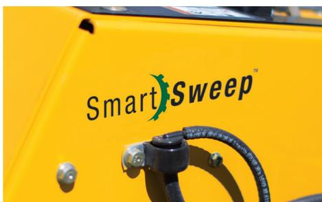
**FLUIDITÉ DE FONCTIONNEMENT.** Le système de commande SmartSweep™ exclusif surveille le régime moteur et apporte des informations en continu pour que la vitesse de balayage de la roue dessoucheuse reste constante et sans à-coups.
