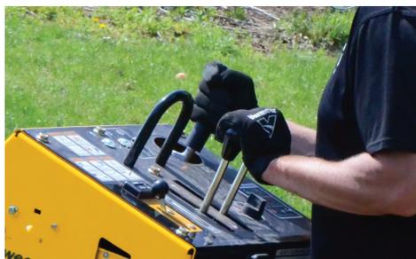
**SYSTÈME DE DÉTECTION DE PRÉSENCE DE L'OPÉRATEUR.** Les poignées de commande du déport de flèche et de levage/descente de flèche sont équipées d'un système de détection de présence de l'opérateur. Ce système a pour but de protéger l'opérateur.
