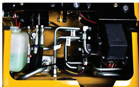
**LA FACILITÉ D'ENTRETIEN AVANT TOUT.** Le radiateur, les composants électriques et les clapets hydrauliques sont accessibles depuis le panneau arrière. Vous avez besoin d'accéder au moteur ? Soulevez simplement la protection latérale pour une maintenance aisée.
