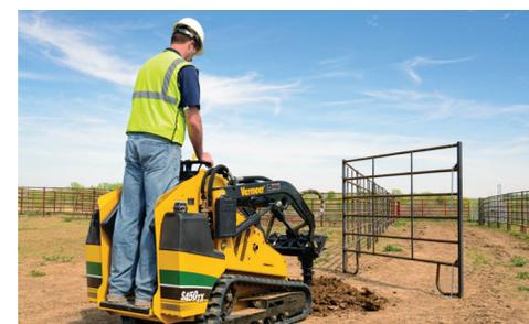
**UNE PLATE-FORME DÉDIÉE AMORTIE PAR RESSORTS** protège l'opérateur de la boue. Le système de détection de présence de l'opérateur intégré permet de stopper le déplacement au sol et l'entraînement de la flèche/godet lorsque l'opérateur descend de la plate-forme.
