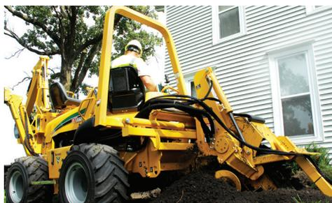
**OPTIONS DE PNEUS.** Le RTX550 est livré avec des pneus standard de 78,7 cm. Pour une meilleure suspension, optez pour l'option de pneus de 88,9 cm.
