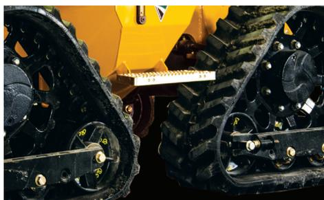
**CONSTATEZ LA DIFFÉRENCE.** Lorsqu'il est équipé du système innovant à quatre chenilles motrices, le RTX550 bénéficie d'une meilleure suspension, les dommages en surface s'en trouvent réduits, l'effort de traction et la stabilité sont plus importants. Les quatre roues directrices et la traction de biais peuvent fonctionner avec ce système.
