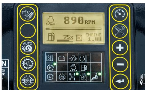
**TOUT EST SUR L'ÉCRAN.** L'écran permet aux opérateurs de naviguer facilement entre les diagnostics machine et les informations sur les performances. L'affichage est multilingue et peut être paramétré suivant les préférences de l'opérateur.
