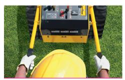
**DIRECTION VZ.** Les opérateurs peuvent facilement manœuvrer la machine grâce aux mancherons, sans que des leviers supplémentaires ou des volants de direction soient nécessaires. Ces mancherons apportent également une pression supplémentaire lors des interventions sur des terrains difficiles.
