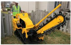
UN PROFIL ÉLANCÉ. La largeur de la machine de 87,6 cm lui permet de s'adapter aux espaces confinés et aux portes étroites.
