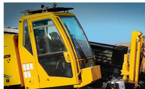
**BEAUCOUP PLUS SILENCIEUSE.** Le D60x90 S3 affiche un niveau sonore garanti de seulement 107 dB(A), ce qui représente 12 dB(A) de moins que le modèle D60x90 précédent. Le résultat ? Un niveau sonore à l'oreille de l'opérateur réduit [83 dB(A)], un confort accru pour l'opérateur et moins de nuisances sonores dans les zones résidentielles ou urbaines.
