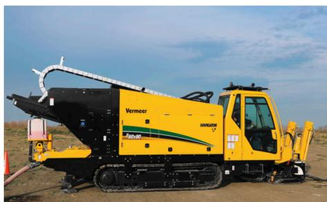
**UN RAPPORT TAILLE-PUISSANCE IMPRESSIONNANT.** La foreuse D60x90 S3 affiche jusqu'à 60 000 lb (267 kN) de poussée/tirage ainsi qu'un couple de rotation de 9 000 ft-lb (12 202,4 Nm) pour une largeur de seulement 100" (254 cm) et une longueur de 26' (7,9 m), ce qui la rend parfaitement adaptée à toute une gamme de spécifications d'installation, même sur les chantiers urbains les plus encombrés.
