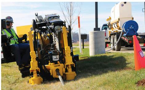
**PLUS DE VITESSE.** Avec une vitesse de chariot de 62,8 m/min et une vitesse de rotation de 219 tr/min, la D23x30 S3 permet aux de poser plus de mètres linéaires par jour et d'optimiser ainsi la productivité et l'efficacité sur le chantier.
