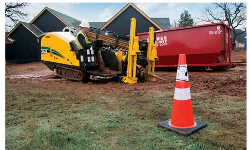
**UN RENDEMENT OPTIMAL.** Avec une poussée/tirage de 106,8 kN et un couple de rotation de 4067,5 Nm, la D23x30 S3 affiche une puissance largement supérieure à celle du modèle D20x22 Série II précédent, ce qui permet d'optimiser le rendement de la machine ainsi que celui du chantier.
