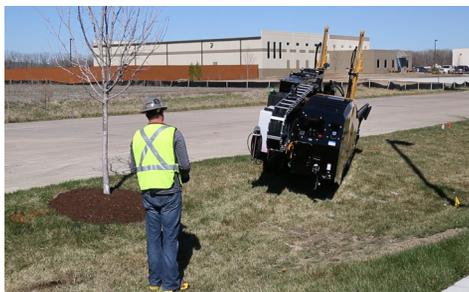
**PLUS VITE SUR LE TERRAIN.** La D23x30 S3 peut se déplacer à 5,3 km/h, ce qui permet aux opérateurs d'arriver sur la prochaine intervention plus rapidement et de graver des pentes ou de négocier des virages plus aisément.
