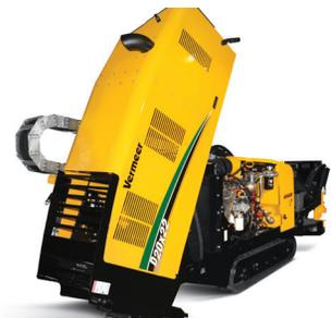
**FACILITÉ D'ENTRETIEN.** Le capot en métal rabattable de la foreuse facilite l'accès pour l'entretien régulier et la maintenance.
