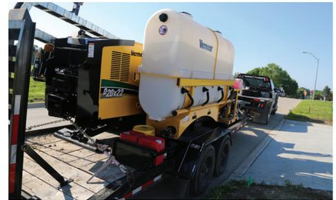
**COMPACTE SELON LES BESOINS.** La foreuse D20x22 S3 est plus courte, plus étroite et plus légère que les modèles concurrents comparables, ce qui permet de l'installer confortablement dans une remorque lorsqu'elle est couplée à un système de mélange.
