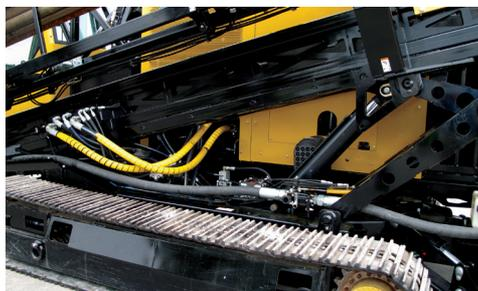
**AUGMENTEZ LA PORTÉE.** La crémaillère de liaison à quatre barres unique et des patins supplémentaires permettent aux opérateurs de paramétrer des angles d'entrée entre 11 et 24°, ce qui augmente la portée accessible lorsque les chenilles reposent entièrement sur le sol.
