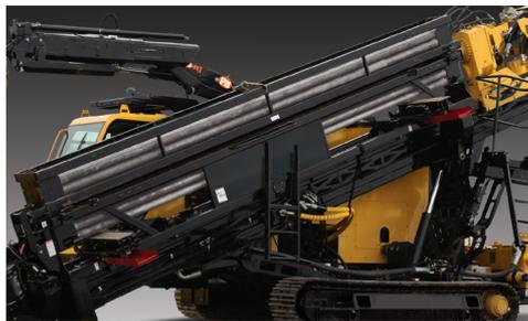
**CAISSONS DE TIGE EMPILABLES.** Les caissons de tige empilables sont simples à utiliser, grâce à une goupille unique et un verrou automatique en attente de brevet.
