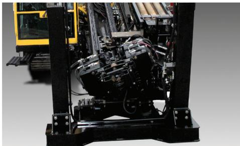
**ÉTAU OUVERT.** Un étau ouvert à la partie supérieure et incliné permet le passage des outils plus larges. Cette large ouverture peut également être utilisée par les opérateurs pour dégager l'outil.
